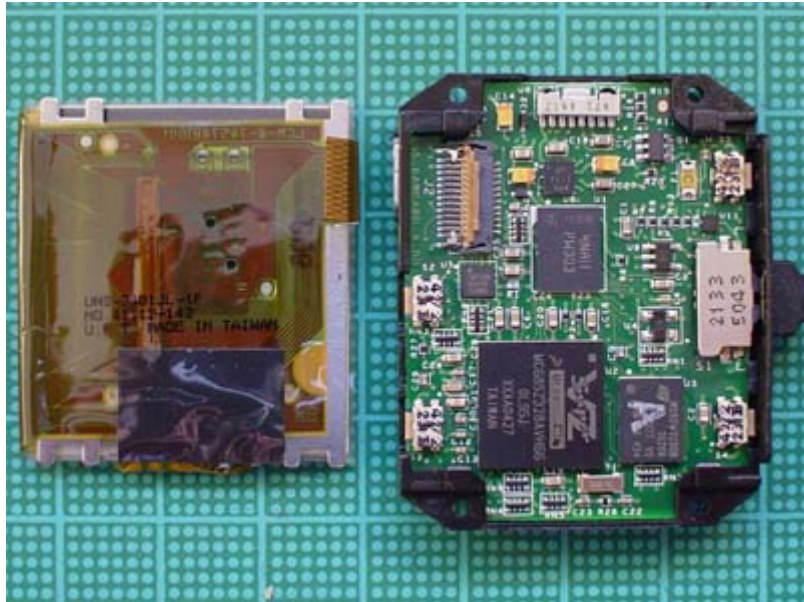
液晶表示部とメイン基板
